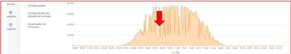
Figura 29: Interrupções e anomalias no processo de geração em horário de pico
