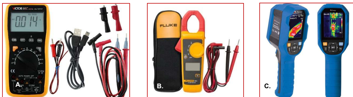
Figura 21: Principais instrumentos de medição utilizados para a verificação elétrica
