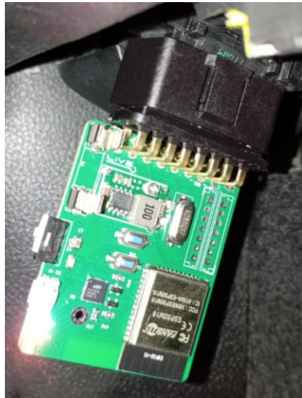
Figura 30 - Sistema Instalado na Porta OBD-II
