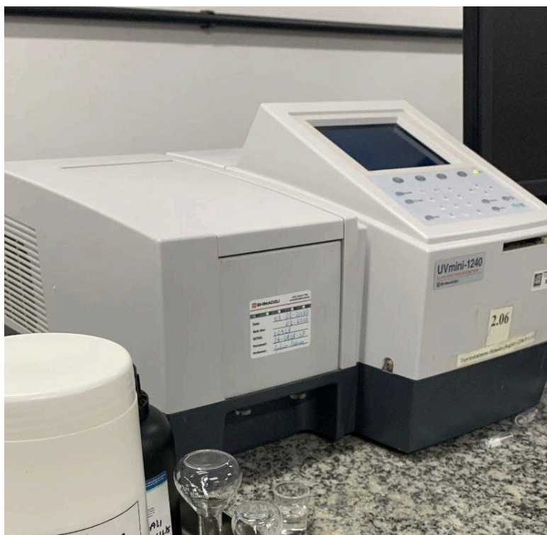
Figura 1 - Espectrofotômetro UV-Vis utilizado para as leituras de absorvância a 760 nm, modelo Shimadzu® UVmini-1240
