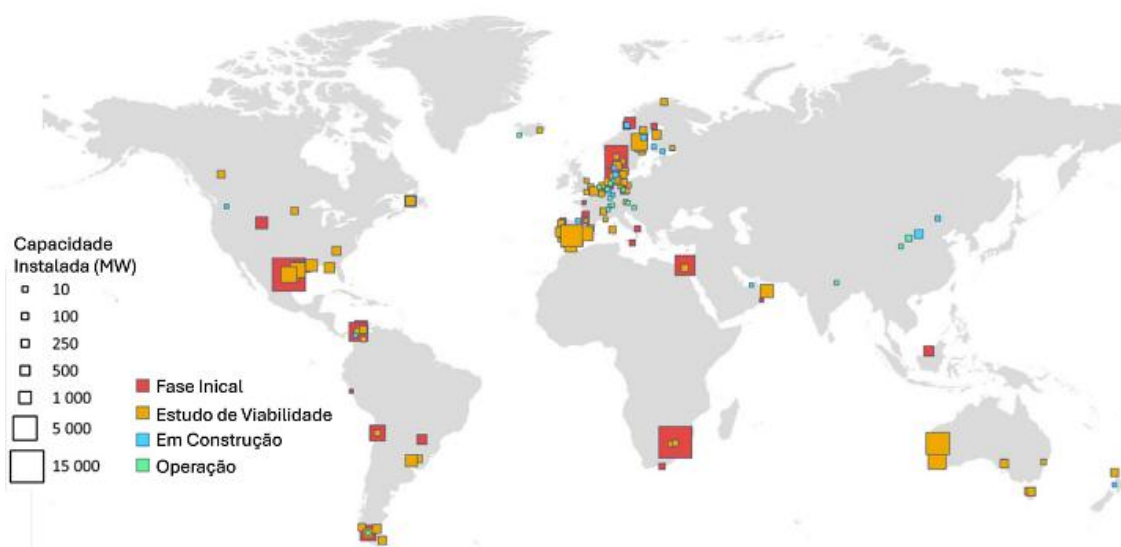
Figura 22 – Capacidade instalada de plantas de produção de e-fuel em diferentes etapas de desenvolvimento no mundo.
