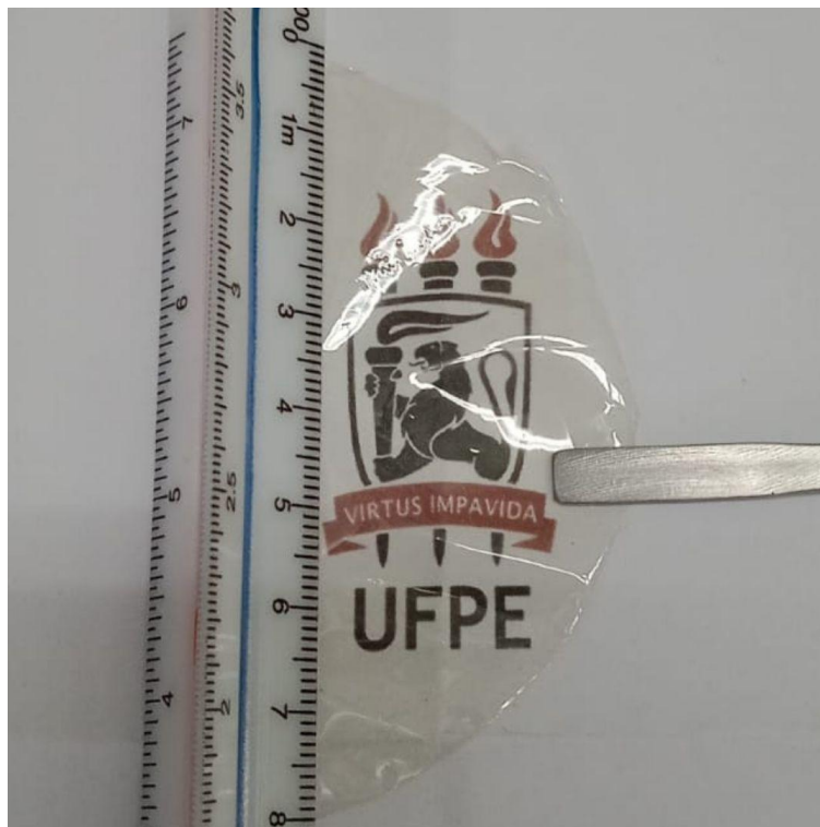
Figura 7. Teste de transparência do filme fino de quitosana pura.
