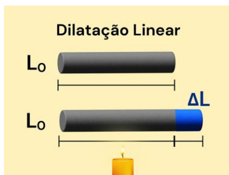
Figura 8: demonstração da dilatação linear de uma barra metálica. Fonte: Brasil Escola
