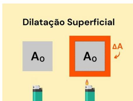
Figura 9: demonstração da dilatação superficial de uma superfície metálica. Fonte: Brasil Escola
