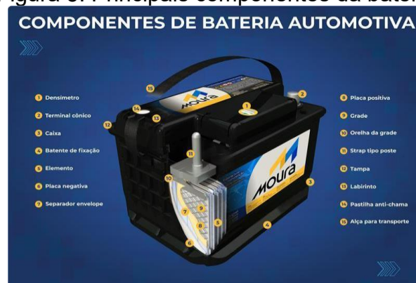
Figura 5. Principais componentes da bateria
