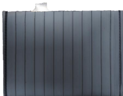
Figura 10. Placa envelopada com um separador de PE
