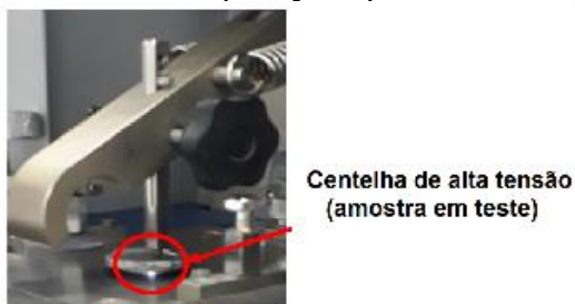
Figura 26. Equipamento de composição química das ligas de Pb. (Spark)
