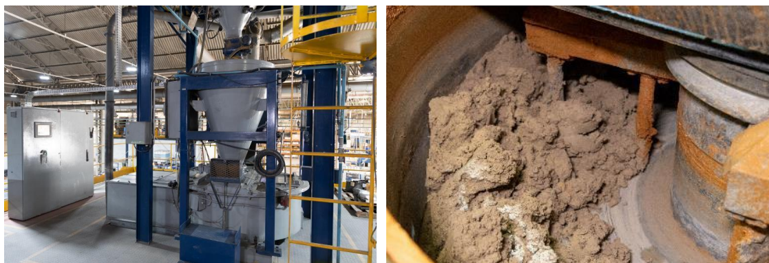
Figura 24. (a)Masseira Industrial Oxmaster da fabricante Wirtz;(b) Massa positiva (a) (b)
