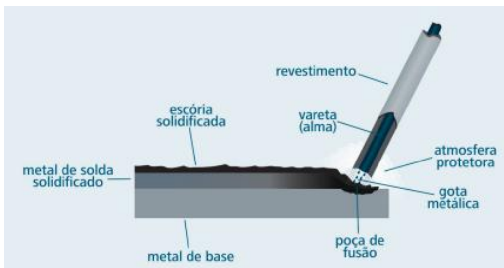
Figura 5. Princípio de funcionamento de soldagem a arco elétrico e eletrodo revestido.
