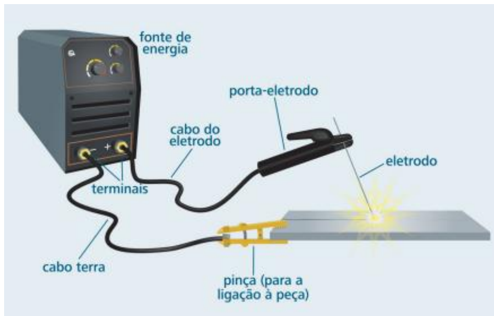
Figura 4. Diagrama esquemático de soldagem com eletrodo revestido.
