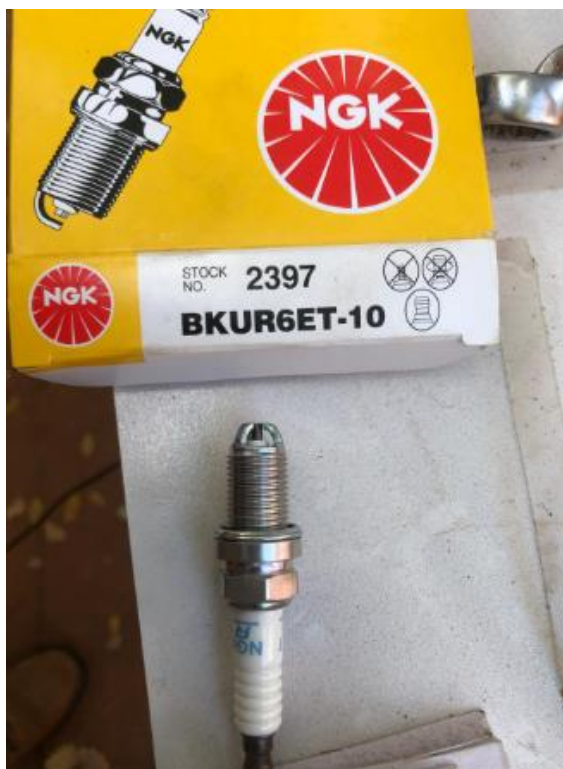
Figura 34 - Vela de ignição com maior área de centelha para suportar altas pressões da turboalimentação no LPG95
