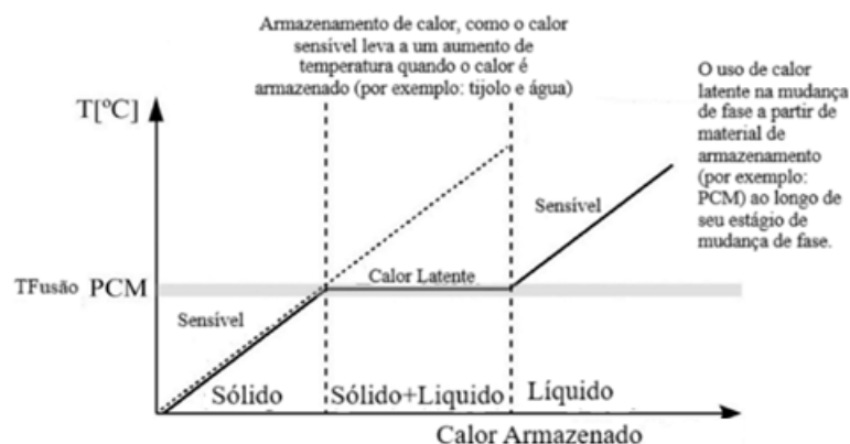
Figura 2.2 - Regiões de transição térmica do PCM.
