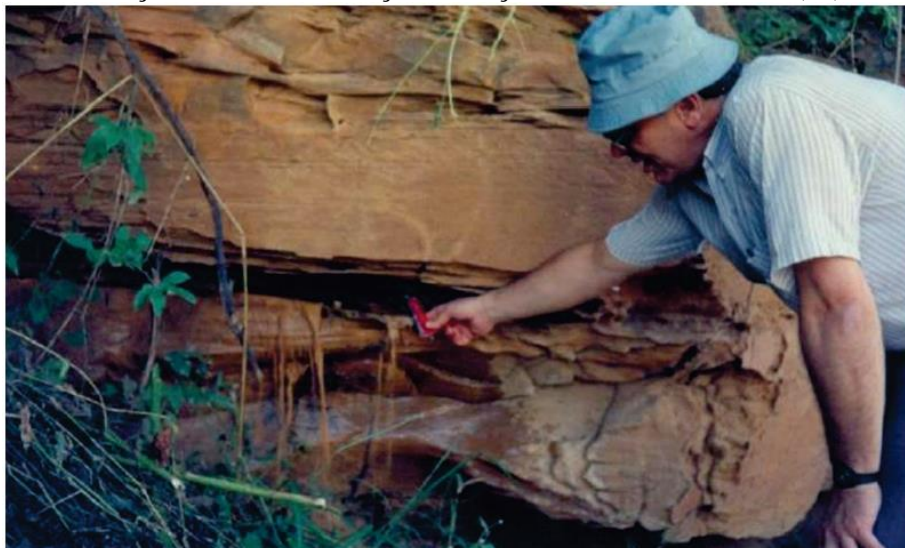
Figura 2.4 - Observação de surgência de água em junta de cisalhamento sub-horizontal em maciço arenítico, formação Cabeças, Bacia do Parnaíba (PI)
