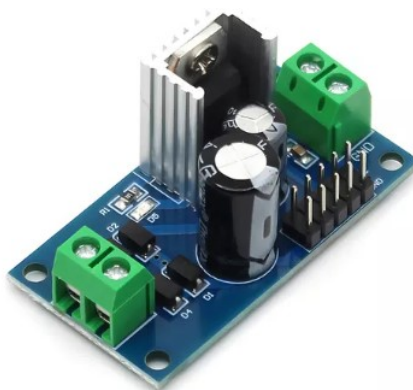
Figura 3.8: Regulador de tensão L7805 utilizado no projeto.
