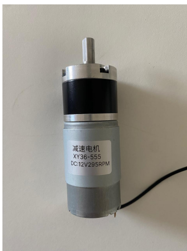
Figura 3.7: Motor CC 555 com redução de 27:1 utilizado no projeto.
