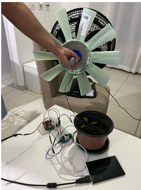
Figura 3.14: Testes de carga e integração com pás de 51cm.
