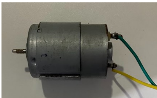
Figura 3.6: Motor CC C7902-2095 utilizado no projeto.
