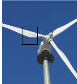
Figura 2-11 Turbina eólica com região cilíndrica na base da pá.
