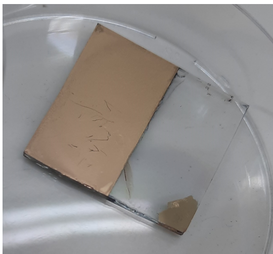
Figura 46 – Célula fotovoltaica ITO/PEDOT:PSS/Perovskita/PCBM/Au
