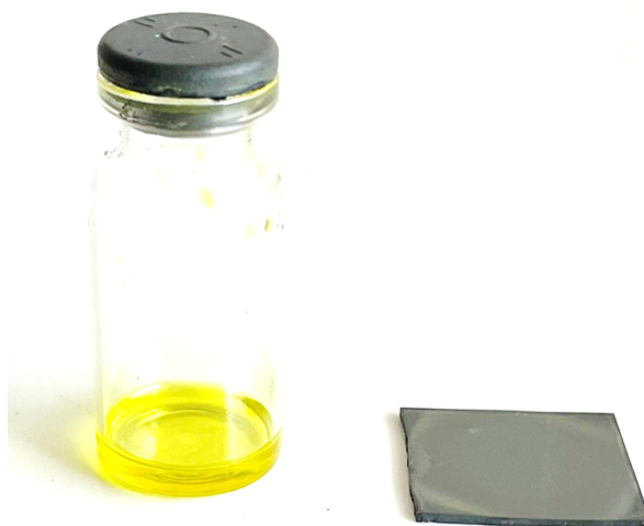
Figura 43 – Solução precursora de perovskita (esquerda) e filme depositado em placa de vidro ITO (direita)
