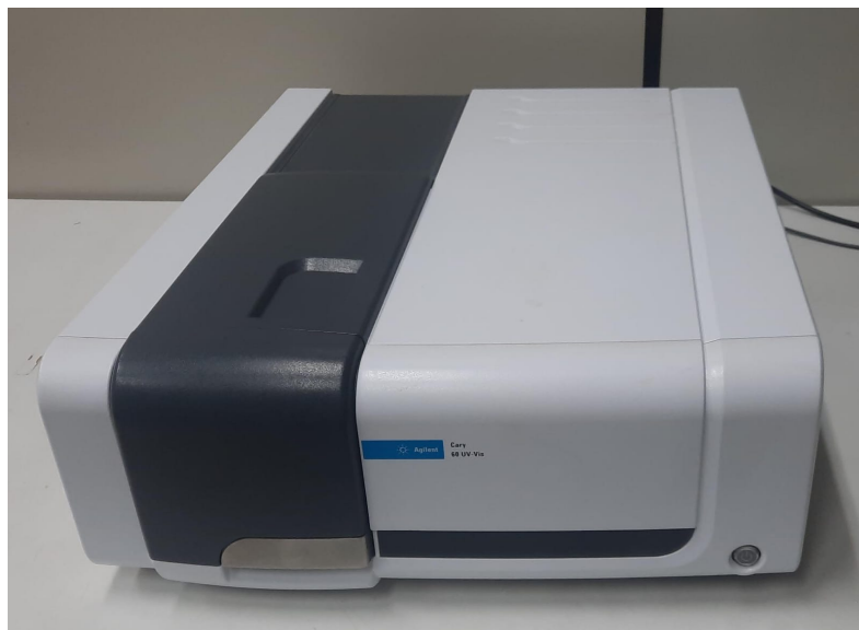
Figura 37 – Espectrômetro UV-VIS Agilent Cary60.
