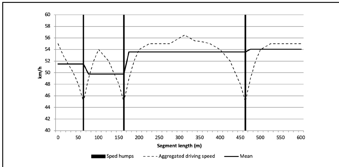
Figura 4 - Estudo da eficácia de lombadas na Dinamarca: Relação entre a velocidade média estimada em projeto e a velocidade média pesquisada no intervalo entre as lombadas
