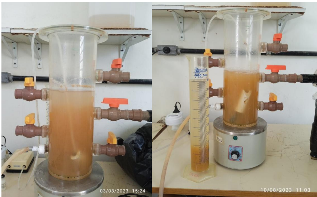
Figura 14 - Antes e depois déficit de biomassa e proliferação de bactérias filamentosas
