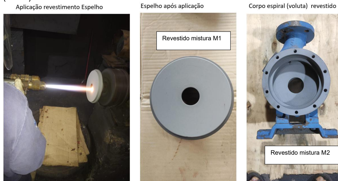
Figura 91 – Placa de vedação (espelho) revestida com a mistura M1 e o corpo espiral (voluta) revestido com a mistura M2.
