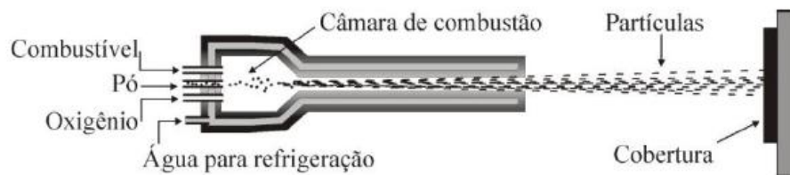
Figura 6 – Esquema de aplicação aspersão térmica pelo processo HVOF
