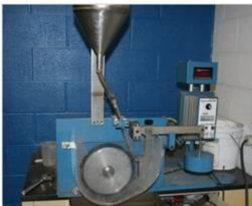
Figura 45 – Imagem de um abrasômetro por roda de borracha para realização de ensaio de desgaste abrasivo conforme a norma ASTM G65-16
