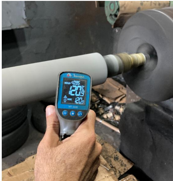
Figura 56 – A imagem mostra o monitoramento da temperatura durante a aplicação dos revestimentos em um êmbolo.
