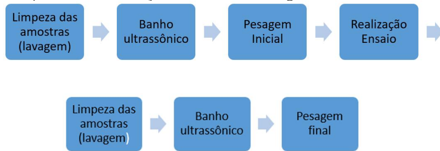
Figura 47 – Sequência da realização do ensaio de desgaste abrasivo
