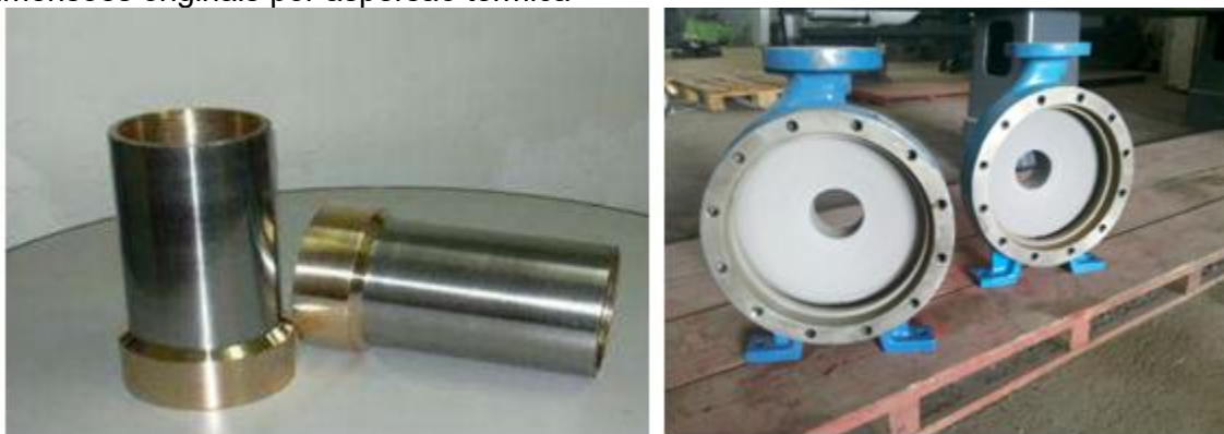
Figura 16 – Componentes de bombas (luvas e corpo espiral) que foram recuperadas suas dimensões originais por aspersão térmica
