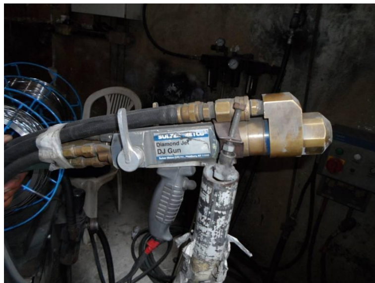
Figura 7 – Pistola/tocha utilizada para aplicação dos revestimentos pelo processo HVOF
