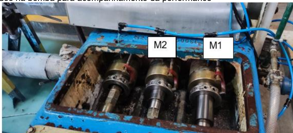
Figura 87 – Imagem dos dois êmbolos revestidos com as misturas M1 e M2 sendo instalados na bomba para acompanhamento da performance
