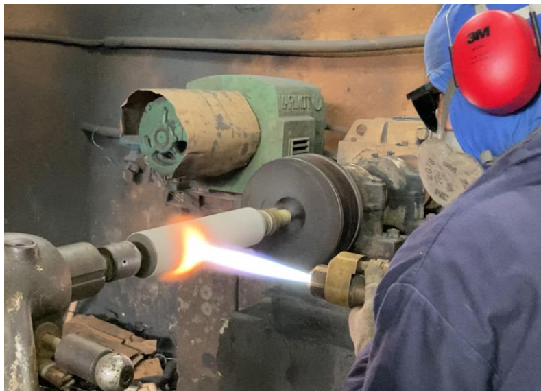
Figura 55 – Aplicação dos revestimentos por aspersão térmica através do processo manual
