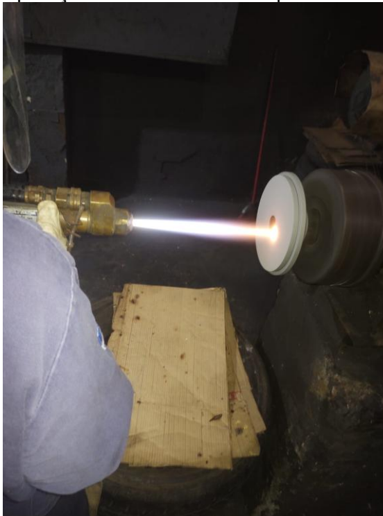
Figura 60 – Imagem da aplicação do revestimento na placa de vedação (espelho)
