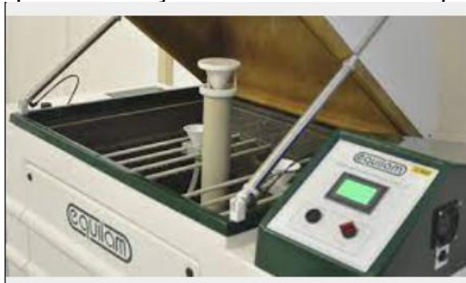
Figura 28 – Equipamento para realização de ensaio corrosão por névoa salina
