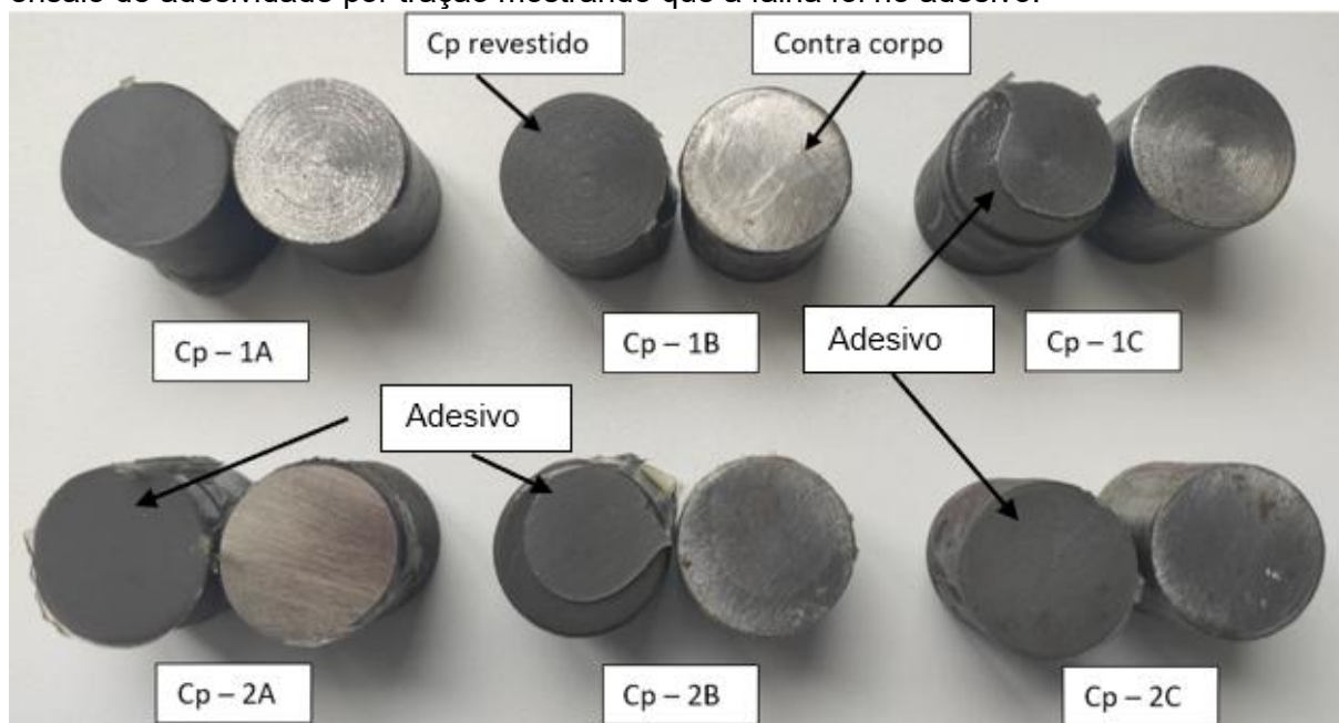
Figura 79 - – Imagem das amostras revestidas com os pós das misturas M1 e M2 após ensaio de adesividade por tração mostrando que a falha foi no adesivo.
