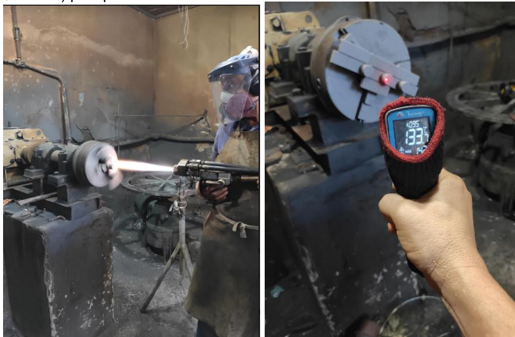
Figura 41 - Aplicação dos revestimentos nas amostras, das misturas M1 e M2 (WC-Co+Cr 3 C 2 -NiCr) pelo processo HVOF
