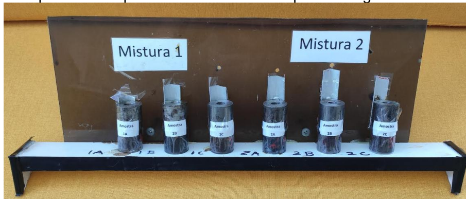
Figura 50 – Dispositivo de apoio das amostras na etapa de colagem
