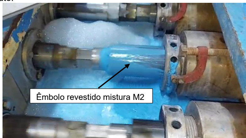
Figura 89 – Imagem do êmbolo revestido com a mistura M2 em operação mostrando um vazando produto.
