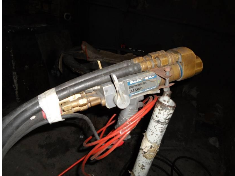
Figura 42 – Imagem da pistola/tocha utilizada na aplicação dos revestimentos por aspersão térmica através do processo HVOF
