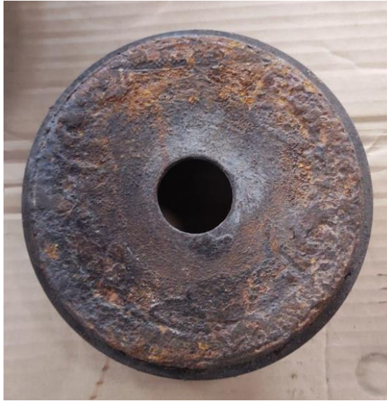
Figura 59 – Imagem da placa de vedação (espelho) antes do jateamento abrasivo e receber o revestimento
