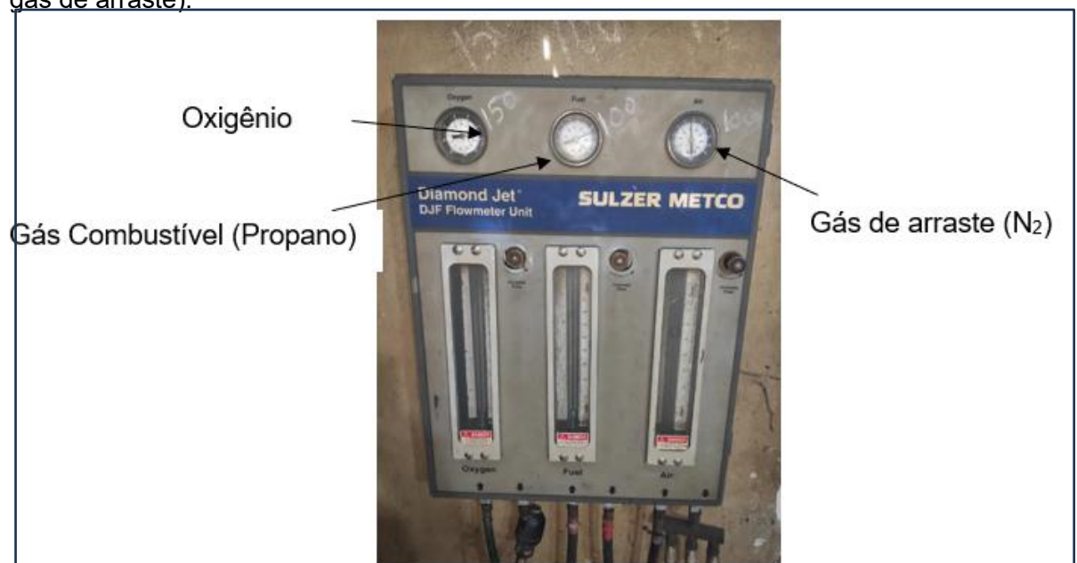
Figura 43 – Painel de controle das variáveis do processo HVOF (oxigênio, combustível e gás de arraste).
