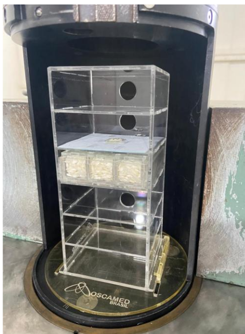
Figura 18- Sistema de irradiação para esterilização de pupas de Aedes aegypti . Gavetas de acrílico contendo cubos com pupas posicionadas no protótipo de irradiação e inseridas na câmara do equipamento Gammacell.
