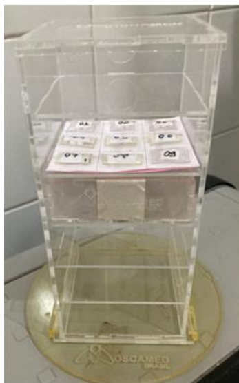
Figura 15 - Dosimetria realizada para verificação da dose recebida pelos mosquitos durante a irradiação.
