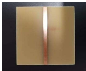
Figura 4.10 Linha de microfita em um substrato de FR-4.
