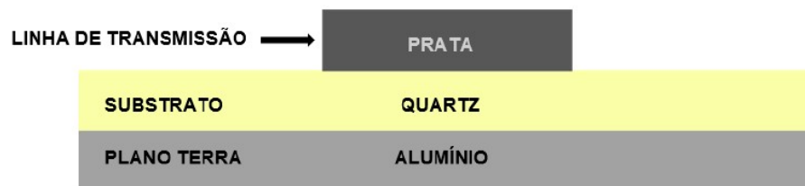
Figura B.2 Corte transversal dos dispositivos.
