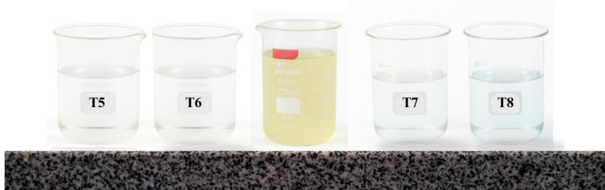
Figura 37 - Amostras T5 a T8 após Fotocatálise Heterogênea Irradiada por Luz Solar por 4h no Efluente Tratado
