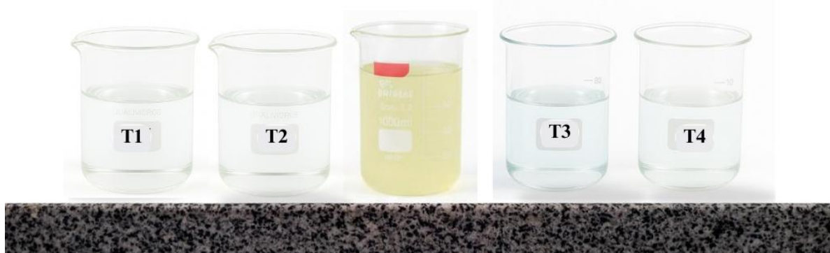
Figura 36 - Amostras T1 a T4 após Fotocatálise Heterogênea Irradiada por Luz Solar por 2h no Efluente Tratado
