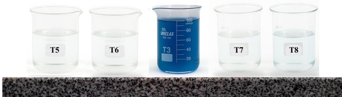
Figura 33 - Amostras T5 a T8 após Fotocatálise Heterogênea Irradiada por Luz Solar por 4h no Efluente Bruto
