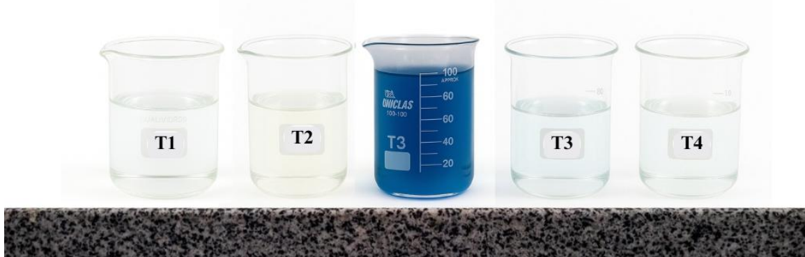
Figura 32 - Amostras T1 a T4 após Fotocatálise Heterogênea Irradiada por Luz Solar por 2h no Efluente Bruto
