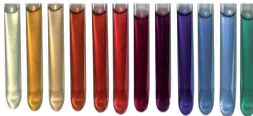
Figura 12 – Cores vistas a partir das diferentes dimensões em função da quantidade de \text{NaBH}_4 adicionados a cada mistura para sintetizar doze colóides de Ag-NPs.
