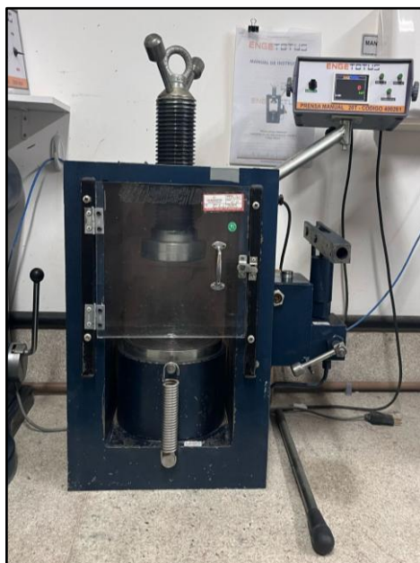
Figura 22 - Prensa manual da Engetotus para o ensaio de resistência à compressão.
