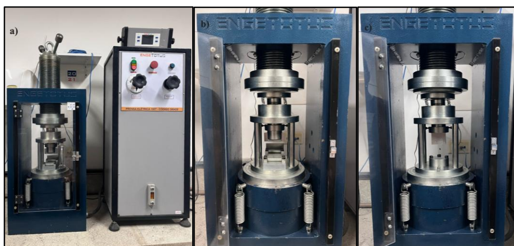
Figura 23 - Prensa elétrica da Engetotus para o ensaio de resistência à tração na flexão (a); Suporte para tração na flexão instalado (b); Suporte para compressão instalado (c).
