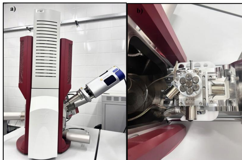
Figura 18 - Equipamento de microscopia eletrônica de varredura (a); Amostras depositadas sobre a fita de carbono no stub e alocadas no equipamento (b).
