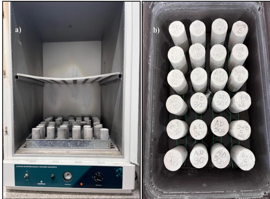
Figura 24 - CPs em processo de secagem na estufa (a); Execução do ensaio de absorção de água por capilaridade (b).
