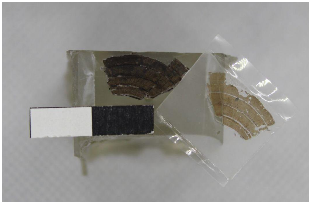
Figura 5 - Exemplo de lenho emblocado em resina acrílica e seu peel resultante (Corte transv. do espécime C.L.).
