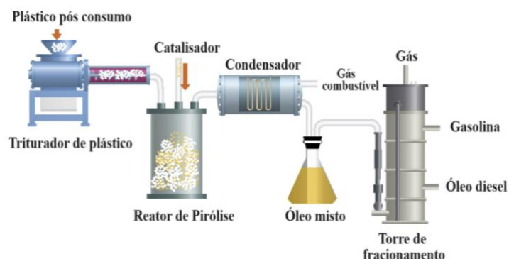
Figura 9 - Fluxograma do processo de pirólise catalítica de plásticos.
