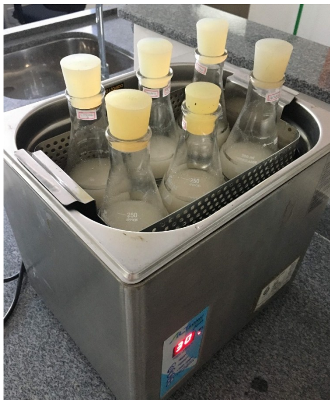
Figura 12: Extração de óleo de licuri com banho ultrassônico.
