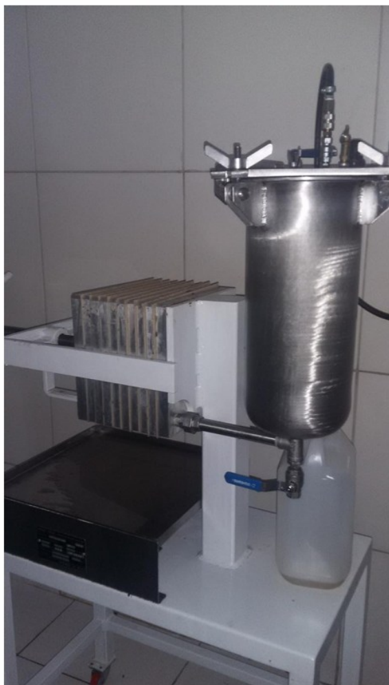
Figura 9: Prensa hidráulica utilizada pela cooperativa COOPES para extração do óleo de licuri.
