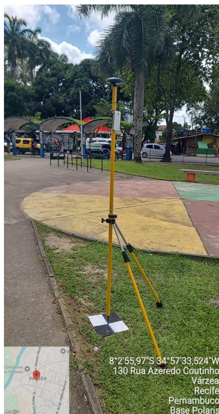
Figura 5 – POLARIS S100 utilizado como Estação Base
