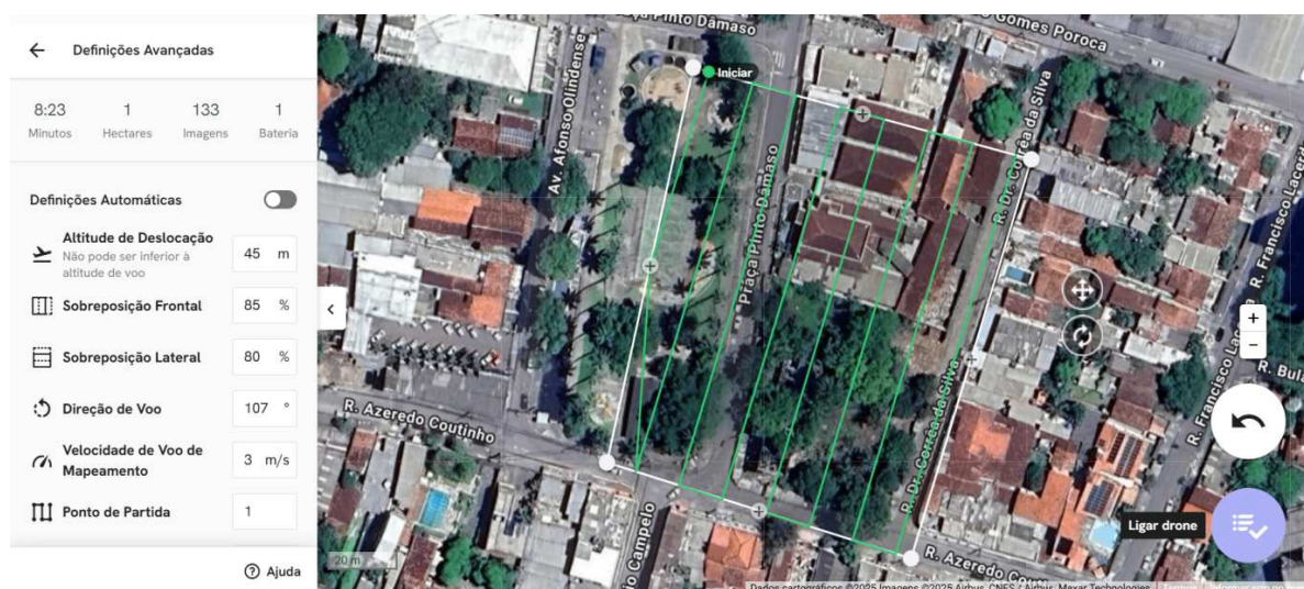
Figura 3 – Parâmetros de voo no DroneDeploy
