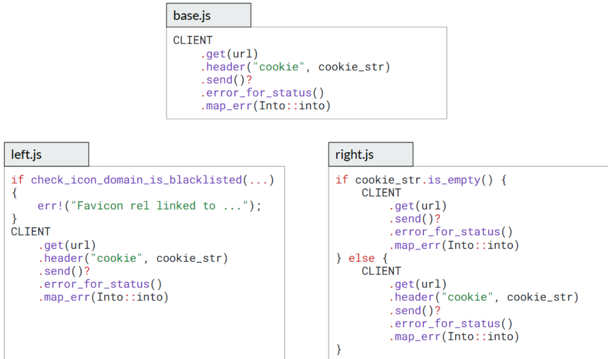
Figura 24 – Revisões de um dos falsos negativos adicionais do Mergiraf em comparação com o SepMerge
