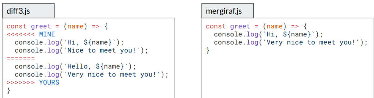
Figura 4 – Resultados da integração das revisões da Figura 3 pelo diff3 e Mergiraf
