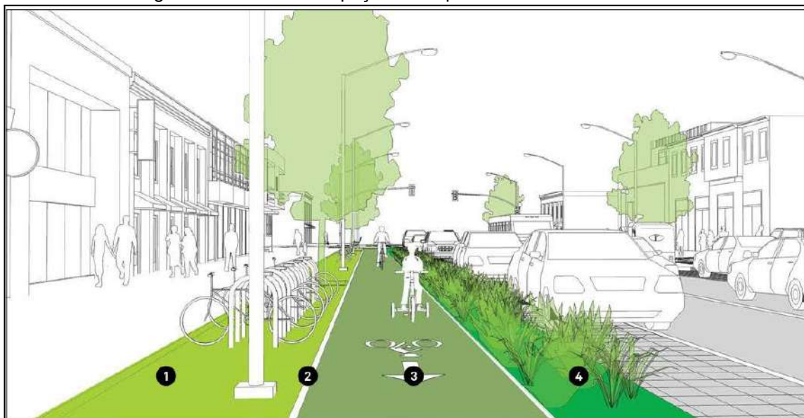
Figura 24: Divisão de espaço básica para estruturas ciclovias
