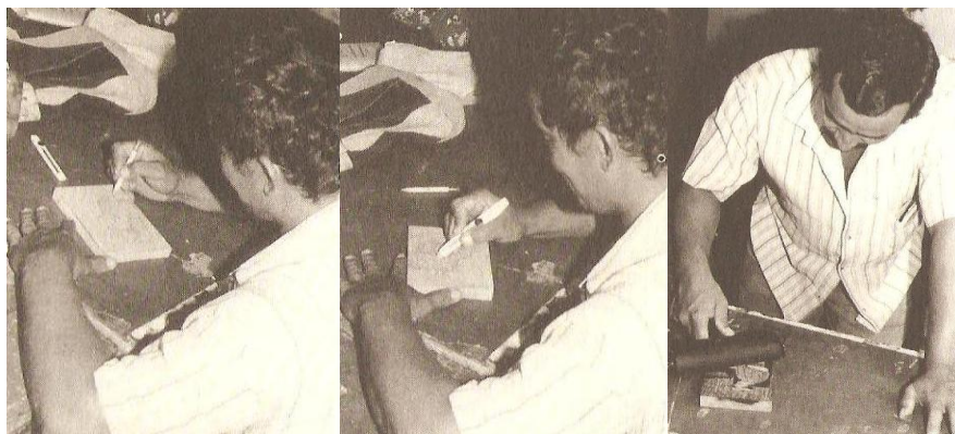
FIG. 3: Processo de desenho, entalhe e entintagem de uma matriz em relevo de madeira.
