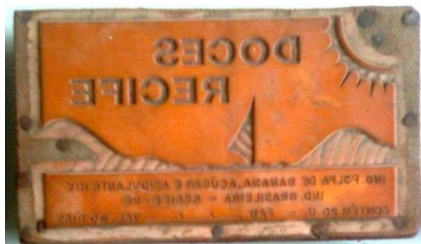
Clichê de borracha lonada gravado pelo processo manual. É possível ver as ranhuras dos instrumentos de gravação nas partes rebaixadas.
