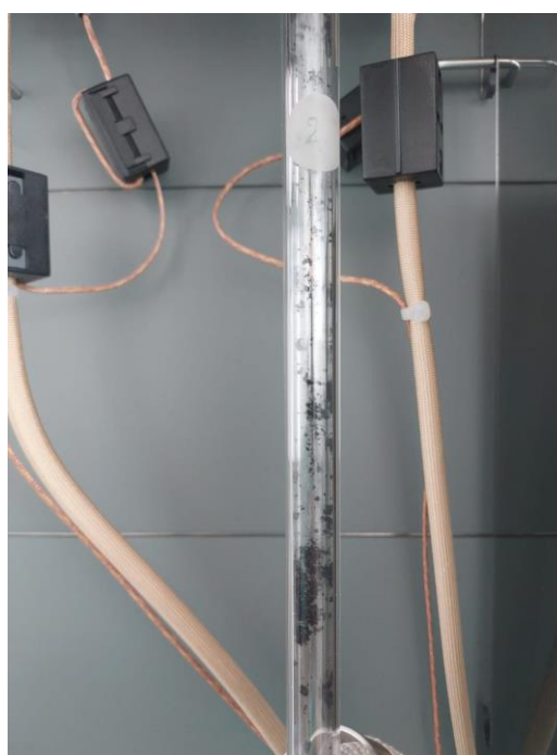
Figura 8 – Óxido de grafeno tio funcionalizado impregnado nas paredes do equipamento para realização da microporosimetria.
