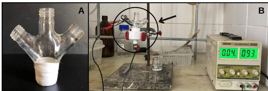
**Figura 12 - A)** Compartimento de vidro; **B)** Célula eletroquímica montada (indicada pela seta) e conectada à fonte DC.
