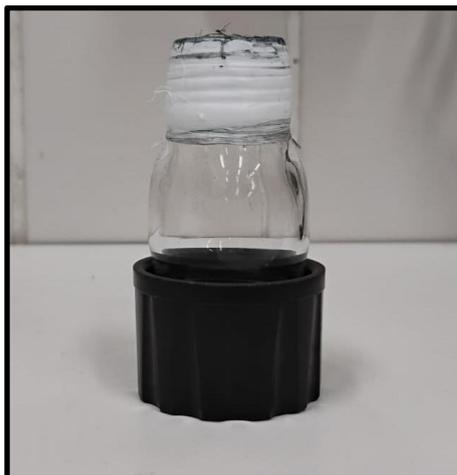
**Figura 13** - Compartimento de vidro utilizado como extrator.
