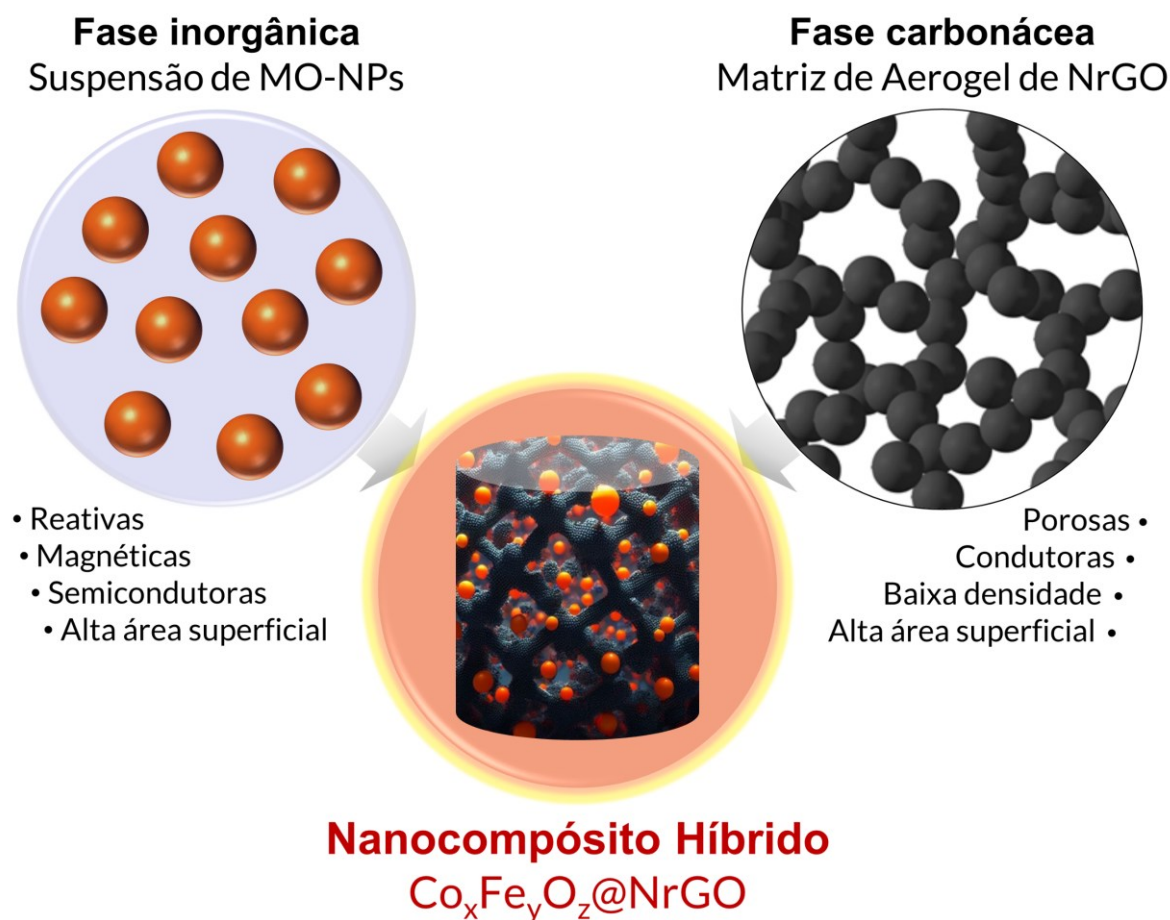
Figura 10 – Esquema ilustrativo da formação do nanocompósito híbrido baseado em fase inorgânica (MO-NPs) e carbonácea (aerogel de NrGO) e suas propriedades individuais
