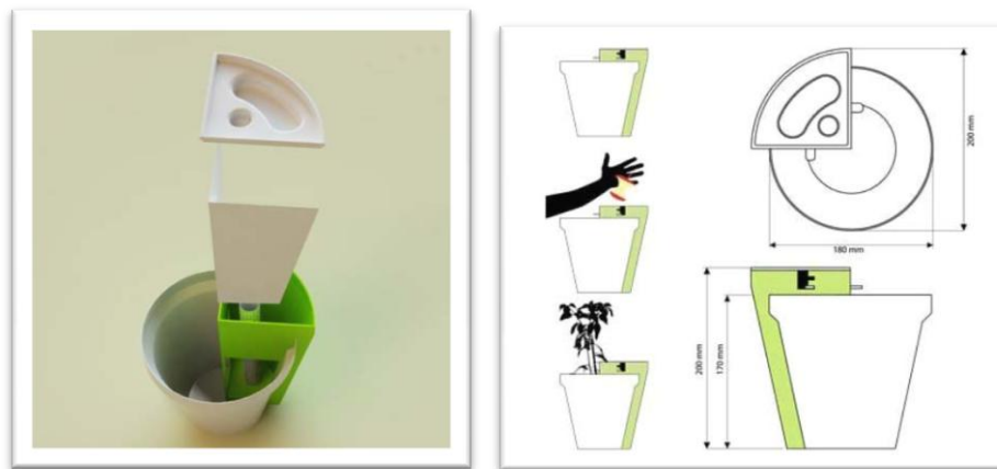
Figura 46 – JARST COMPOSTEIRA CASEIRA COMPONENTES E DIMENSÕES
