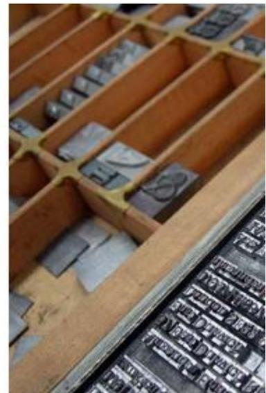
Figura 01, 02 e 03. Respectivamente: Matrizes, Tipos Móveis e Caixa tipográfica.
