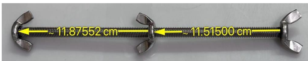
Figura 4 - Demonstração de como é feita a aferição dos lados da haste 3D
