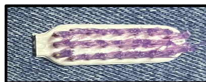
Figura 20. Delimitação para o corte da escova padrão Descart (São Paulo, SP, Brasil) para a realização do ensaio de higiene mecânica.
