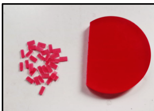
Figura 13. Disco PMMA de resina compactada VIPI-BLOCK-VIPI (Pirassinunga, São Paulo, SP, Brasil) seccionado para o tamanho amostral.
