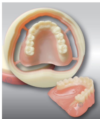
Figura 4. Prótese Total Digital CAD-CAM fresada, realizada com disco de PMMA compactada monolítico multicolor Ivotion , Ivoclar Vivadent . São Paulo, SP, Brasil.
