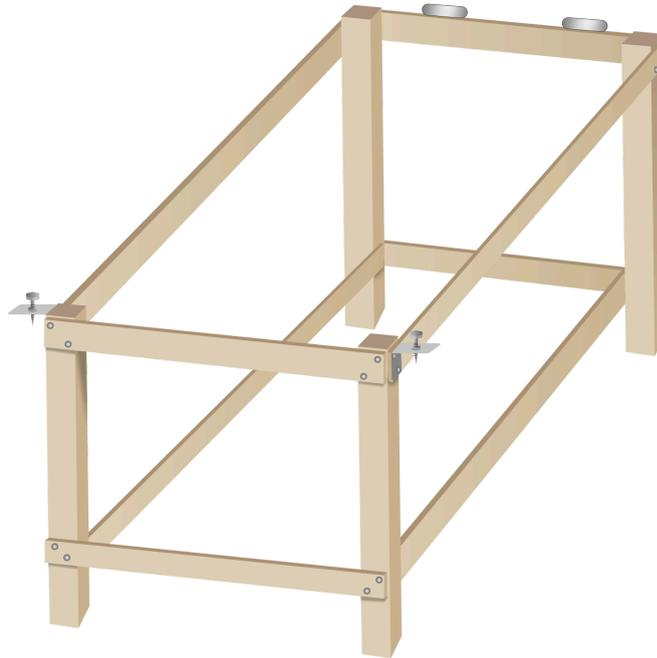
Figura 6: Ilustração da estrutura de mesa de apoio do equipamento em madeira. Medidas - Altura: 0.7m; Largura de 0.7m e Comprimento: 1.7m. Fonte: A autora, 2024.
