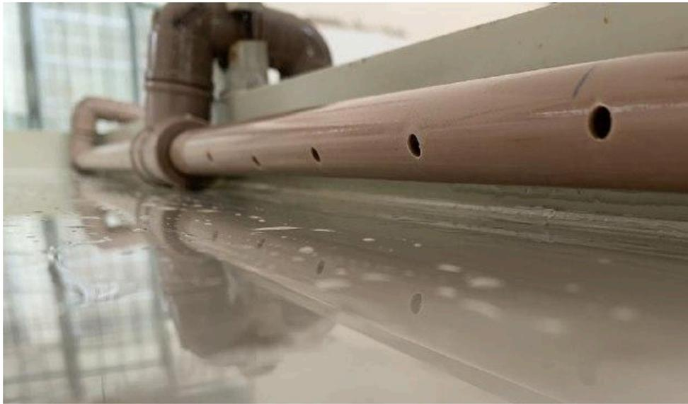
Figura 10: sistema de irrigação do ATS com furos de saída de água. Fonte: A autora, 2024.
