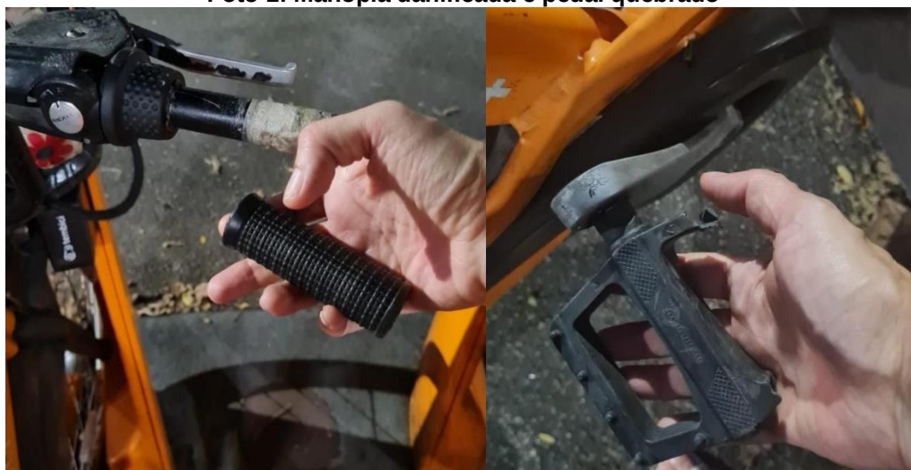
Foto 1: Manopla danificada e pedal quebrado
