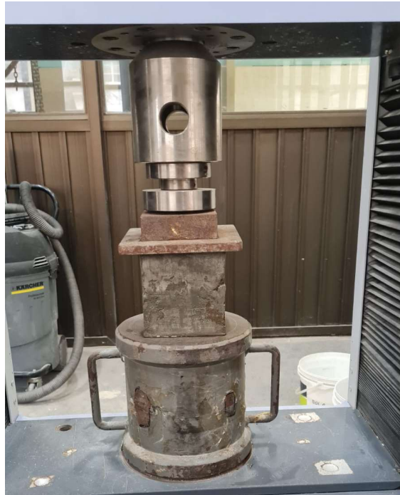
Figura 61 – Tijolo disposto na prensa para início do ensaio de resistência à compressão.
