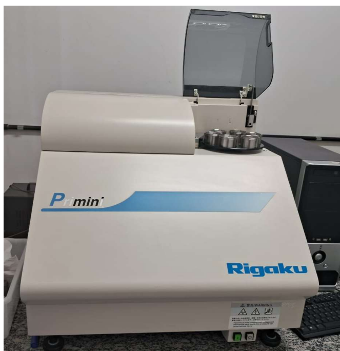
Figura 38 – Espectrômetro utilizado na pesquisa para análise de FRX.
