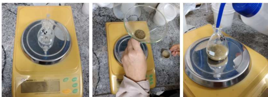
Figura 33 – Picnômetro vazio, solo adicionado com funil e adição de água destilada.
