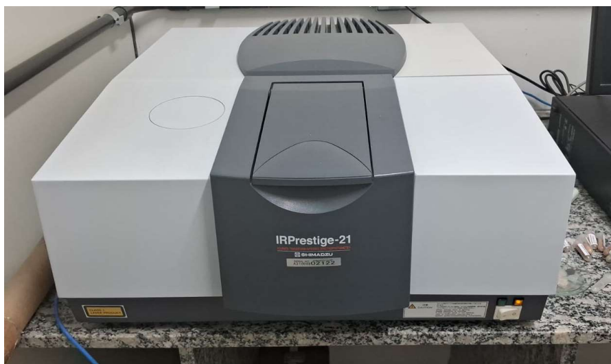
Figura 41 – Espectrofotômetro utilizado na pesquisa para análise de FTIR.
