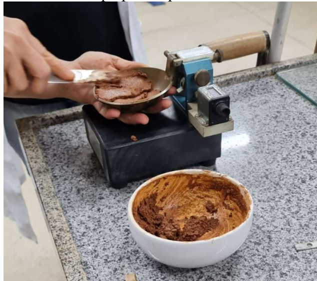
Figura 16 – Amostra sendo preparada para o ensaio de Limite de Liquidez.
