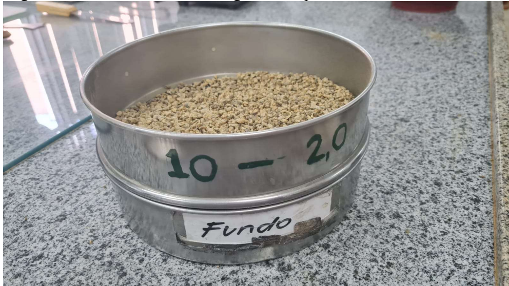
Figura 20 – Peneiramento do solo grosso em peneira de abertura de 2,0 mm.
