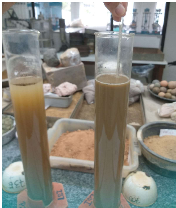
Figura 126 – Aferição de sedimentação com densímetro.
