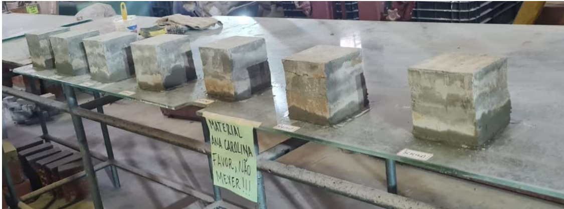
Figura 57 – Tijolos cimentados no meio e nas duas faces.
