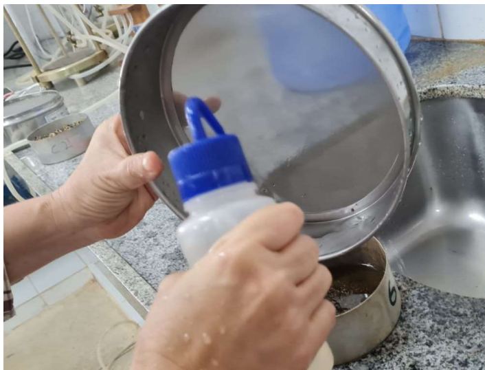
Figura 24 – Solo retido após lavagem sendo retirado da peneira para secagem em estufa.
