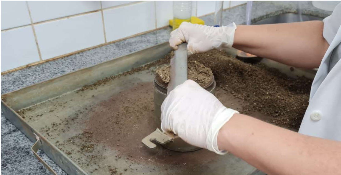
Figura 30 – Rasamento do molde com régua biselada.
