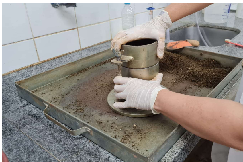
Figura 29 – Molde complementar e base do cilindro sendo removidos.
