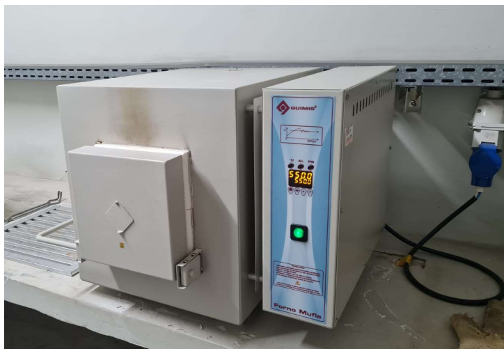
Figura 37 – Mufla do LSA-UFPE utilizada no ensaio de perda ao fogo.
