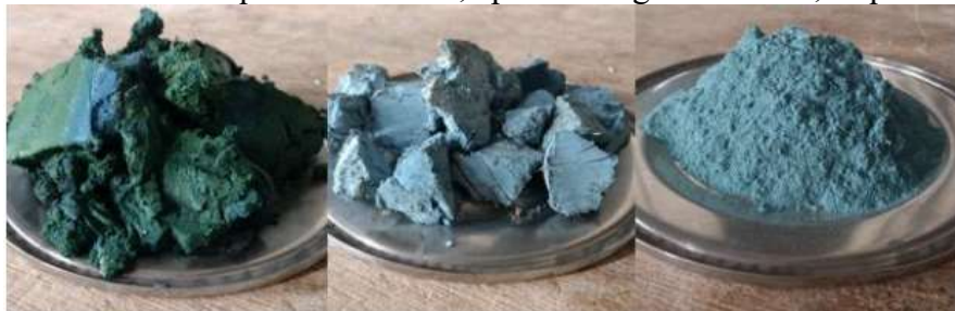
Figura 10 – Lodo têxtil quando coletado, após a secagem e moído, sequencialmente.
