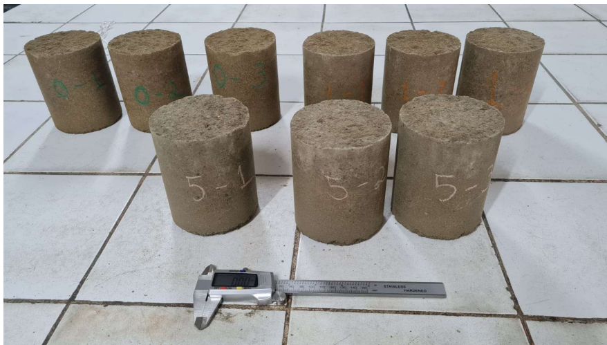
Figura 65 – Três grupos de corpos de prova cilíndricos a serem medidos com paquímetro.
