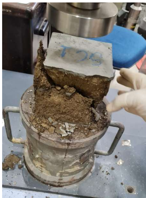
Figura 62 – Tijolo rompido sendo retirado da prensa.
