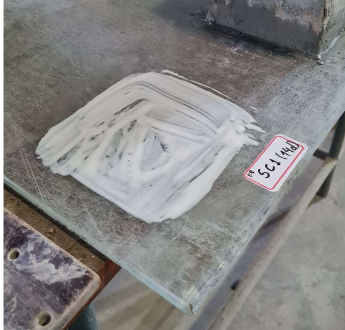
Figura 165 – Desmoldante aplicado em placa de vidro para receber pasta de cimento e tijolo.
