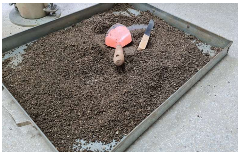
Figura 137 – Material homogeneizado para ensaio de compactação.
