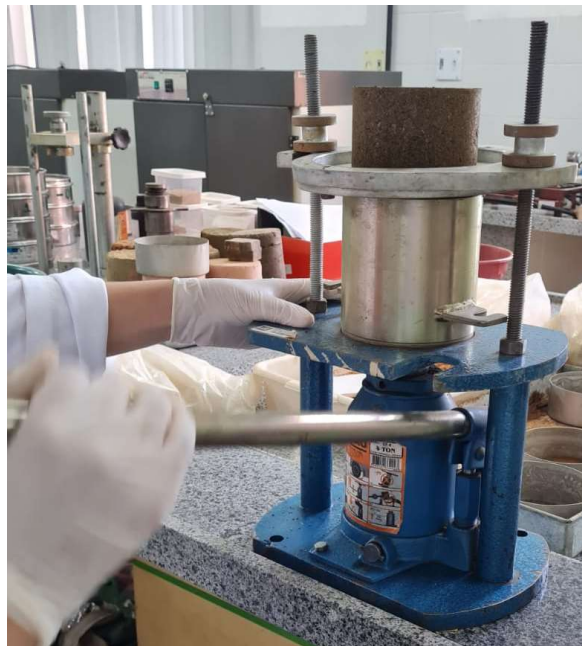
Figura 31 – Amostra sendo retirada do molde com extrator mecânico.
