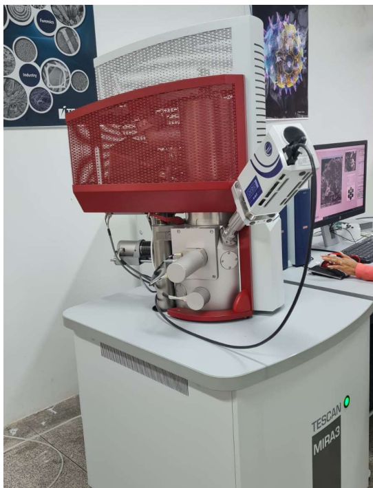
Figura 42 – Microscópio Eletrônico de varredura do INTM utilizado para a análise.
