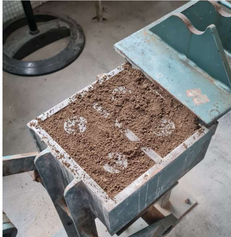
Figura 50 – Mistura de solo-cimento na prensa antes da compactação.
