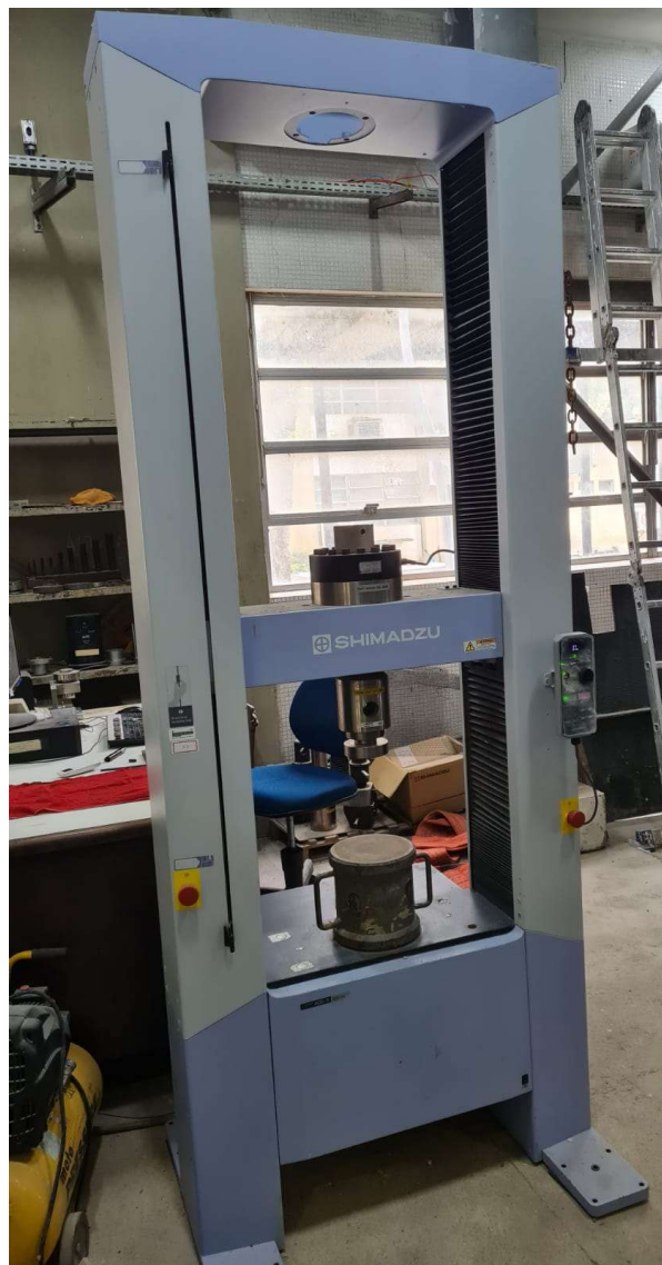
Figura 60 – Prensa de ensaio de resistência à compressão.
