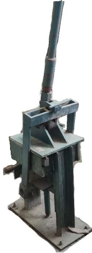
Figura 48 – Prensa de tijolos de solo-cimento.
