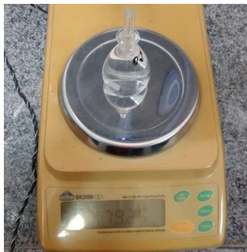
Figura 36 – Picnômetro limpo, cheio de água destilada para obtenção do peso 4.
