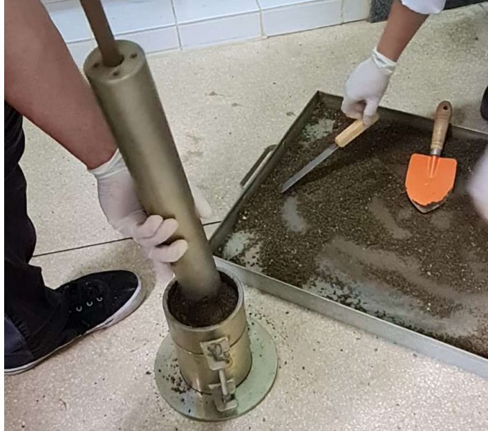
Figura 28 – Processo de compactação do solo no cilindro.
