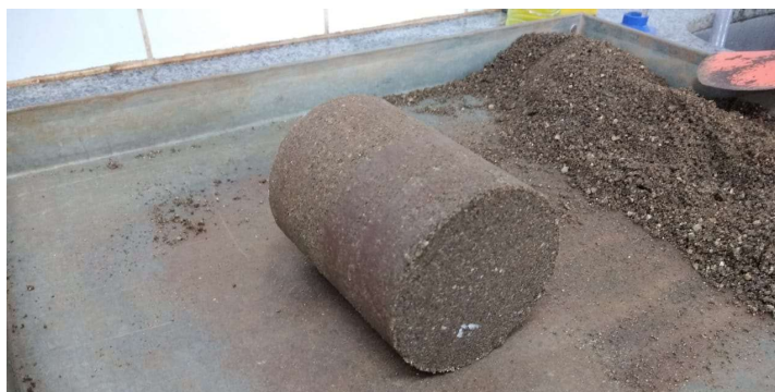
Figura 32 – Molde na bandeja para retirada de amostras seguida do destorroamento.
