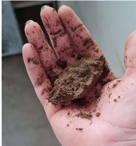
Figura 46 – Teste de umidade com as mãos, segundo ABCP.
