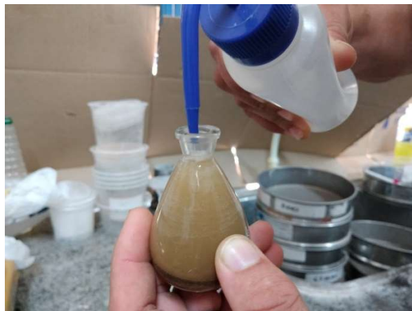
Figura 35 – Adição de água destilada no picnômetro após retirada de ar do material.
