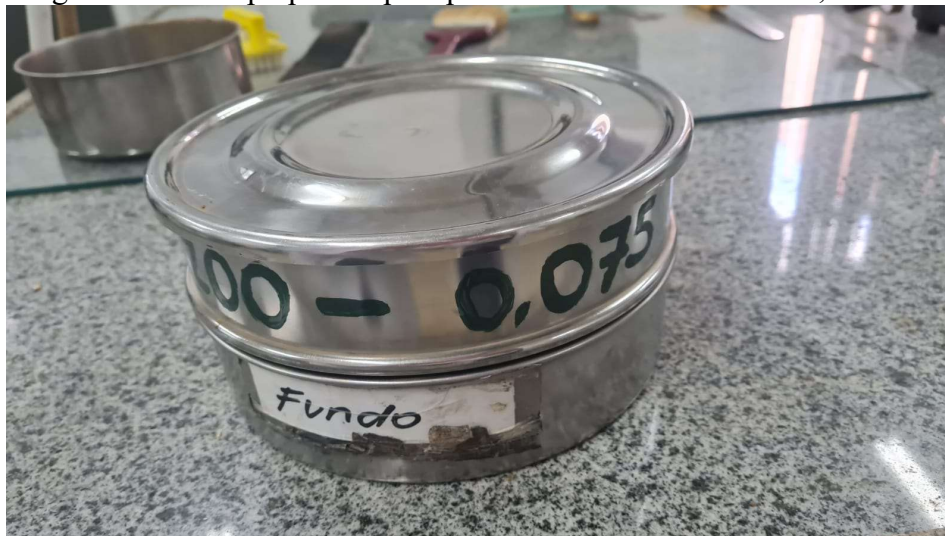
Figura 22 – Solo preparado para peneiramento a abertura de 0,075 mm.
