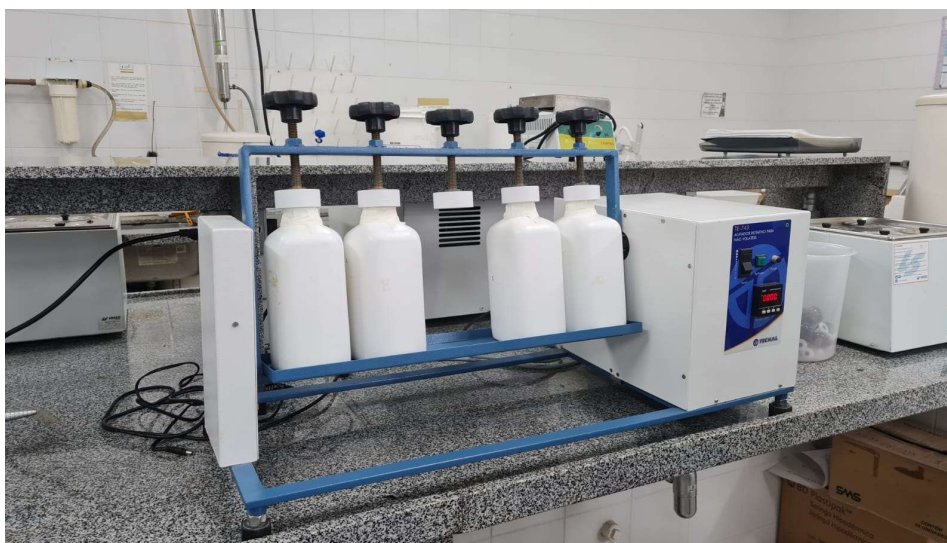
Figura 43 – Ensaio de lixiviação das amostras de tijolo de solo-cimento com lodo têxtil.
