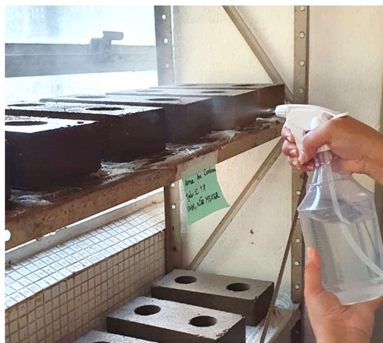
Figura 53 – procedimento de cura dos tijolos.
