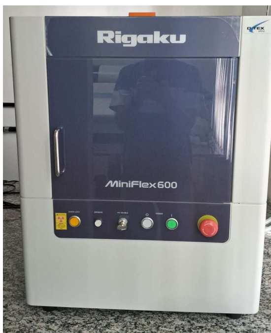
Figura 40 – Difratorômetro utilizado na pesquisa para análise de DRX.
