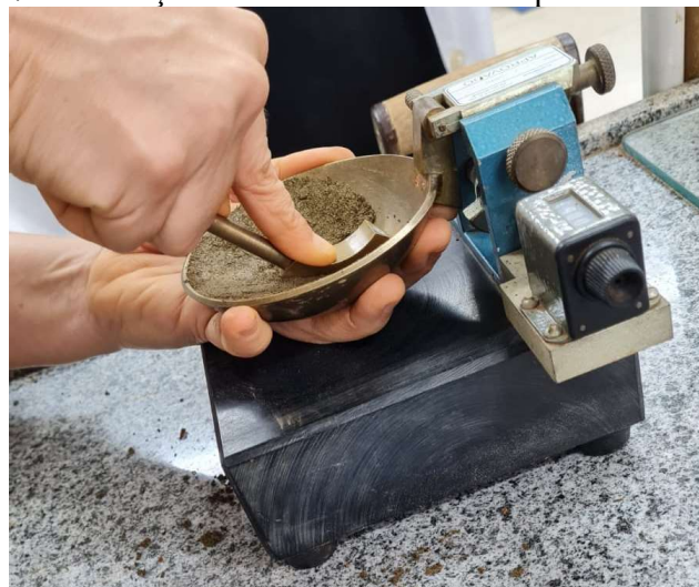
Figura 17 – Execução de ranhura com cinzel para o ensaio de LL.
