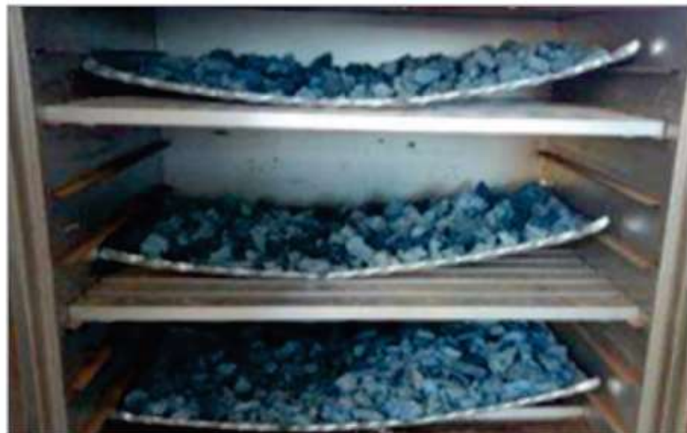
Figura 9 – Lodo têxtil secando em estufa.
