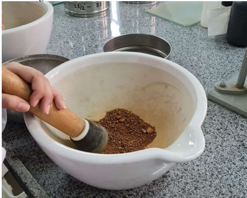
Figura 14 – Processo de destorroamento dos solos.
