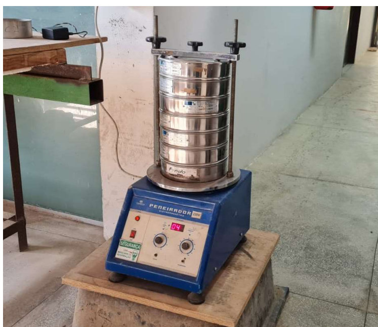
Figura 25 – Peneiramento grosso em peneirador eletromecânico.
