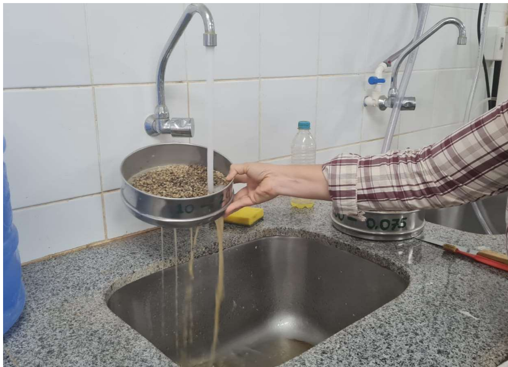
Figura 21 – Solo retido na peneira de 2,0 mm sendo lavado para retirada dos finos.
