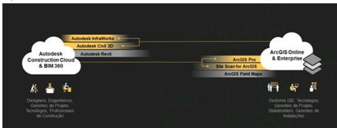
Figura 19: Possibilidades de conexões entre os ambientes Cloud e desktop da Esri e Autodesk
