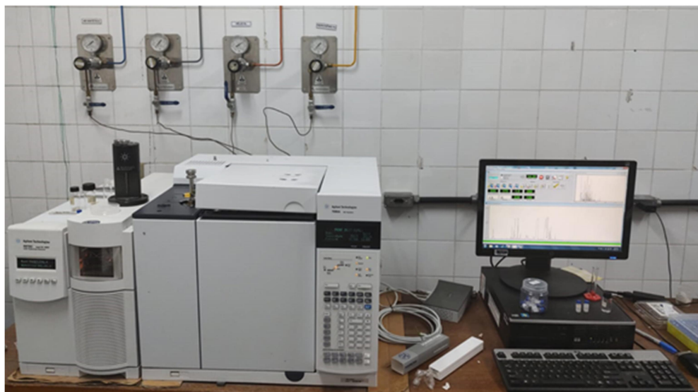
Figura 36 - Cromatógrafo gasoso acoplado à espectrometria de massas (CG/EM)
