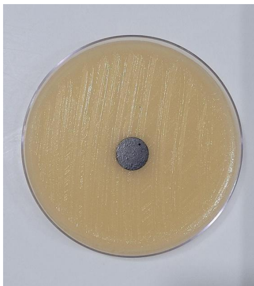
Figura A5 – Teste de formação de halo de inibição do rGO frente a cepa de Staphylococcus epidermidis .
