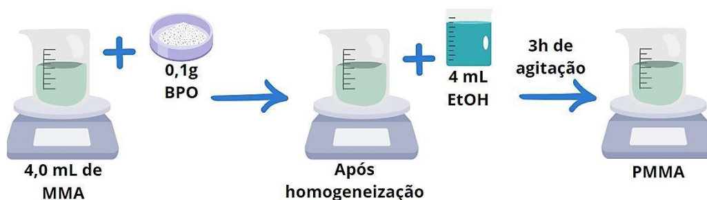
Figura 6 - Rota de síntese do Poli metil metacrilato (PMMA).
