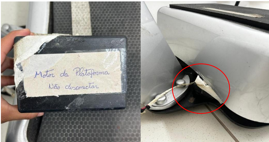
Figura 6: Dispositivo Sham acoplado a base da plataforma para simular a vibração. Fonte: Acervo pessoal do autor (2024)
