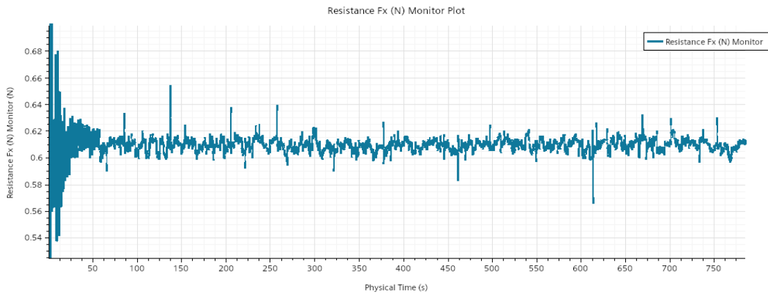
Figura 4.2.5 - Componente da força na direção x do modelo ao longo do tempo com os bulbos modificados a cada quatro segundos.
