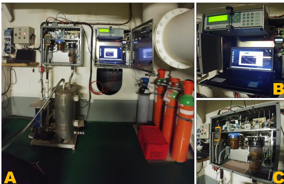
Figura 3 - A - Sistema underway para \text{CO}_2 instalado no Navio Mercante Cap. San Lorenzo; B – Compartimento seco, com computador e o detector infravermelho de \text{CO}_2 da Licor 7000; e o C – compartimento molhado, com os equilibradores, que têm a função de equilibrar a p\text{CO}_2 da água que flui pelo sistema
