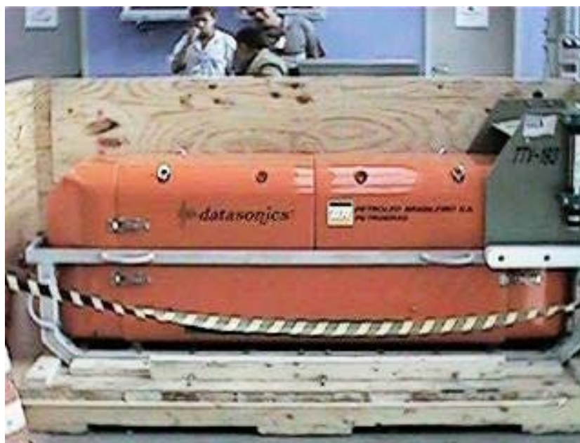
Figura 13: sistema (peixe) deep towed SIS 3000 usado neste estudo (foto retirada de Maldonado et al., 2003).
