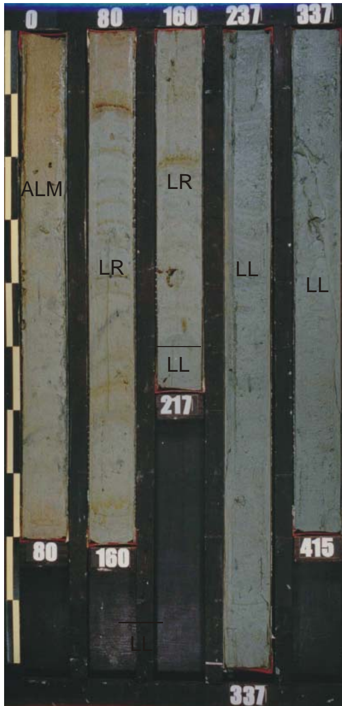
Figura 41: foto do testemunho K-55 com as litologias observadas. Descrição Petrobras UN-BC/ATEX/LG.
