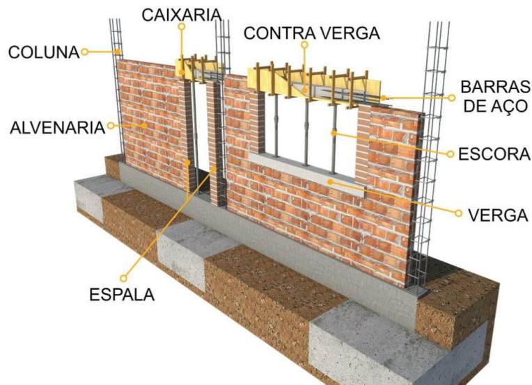
Figura 2 - Elemento de vedação: Parede de Alvenaria
