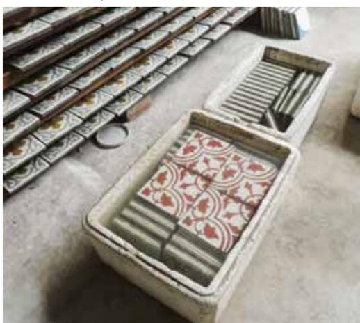
**Figura 8. Processo de fabricação - Cura**
