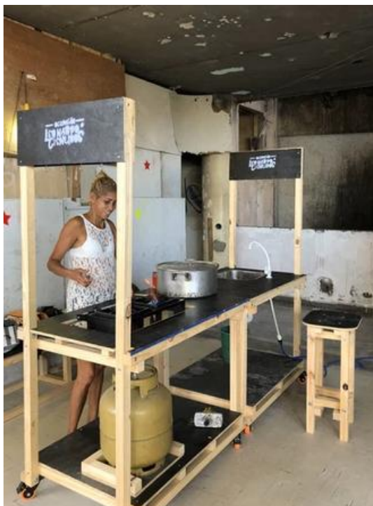
Figura 81 - Cozinha coletiva com estrutura móvel e módulos independentes construída na ação
