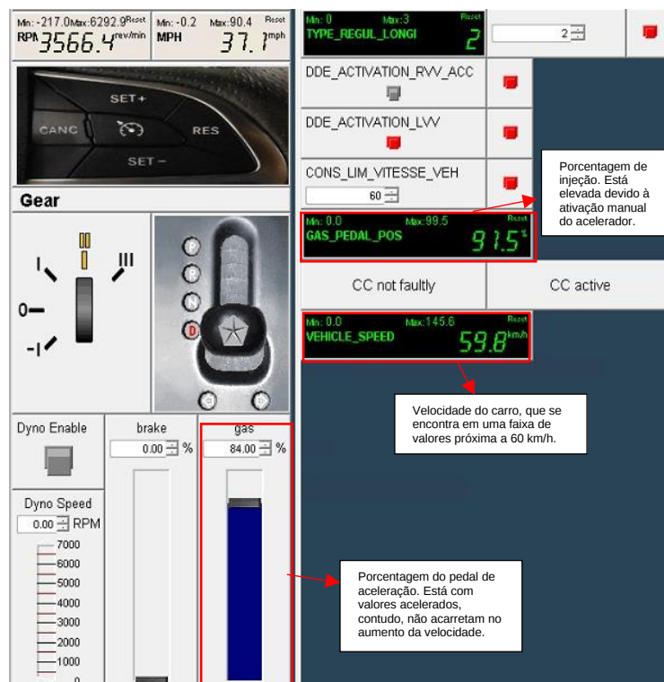
Figura 20 – Realização do teste da função Speed Limit feita no Provetechn:TA.
